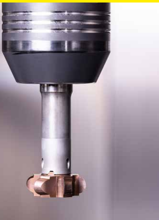
Götz fraise les gorges avec une fraise à rayon complet.
