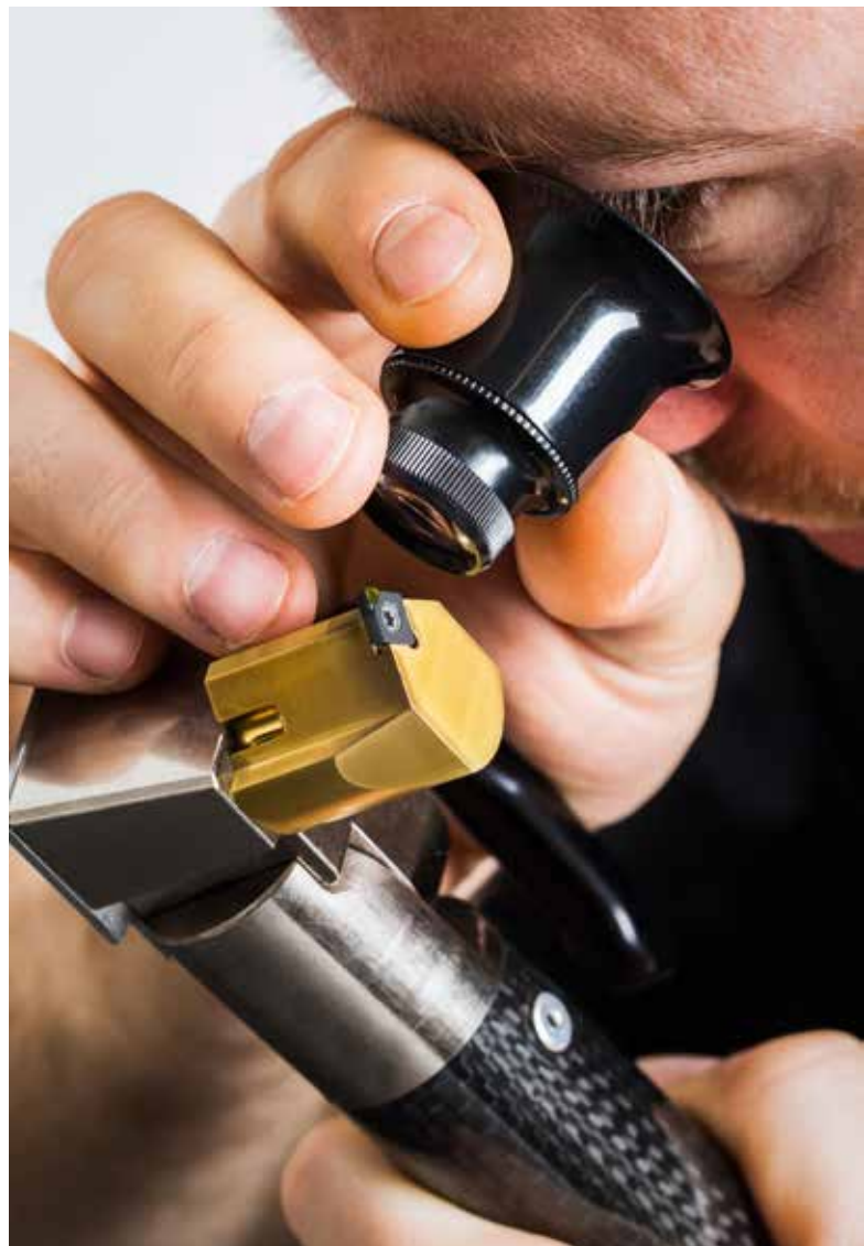
Service de réaffûtage : les lames MCD peuvent être réaffûtées plusieurs fois.
