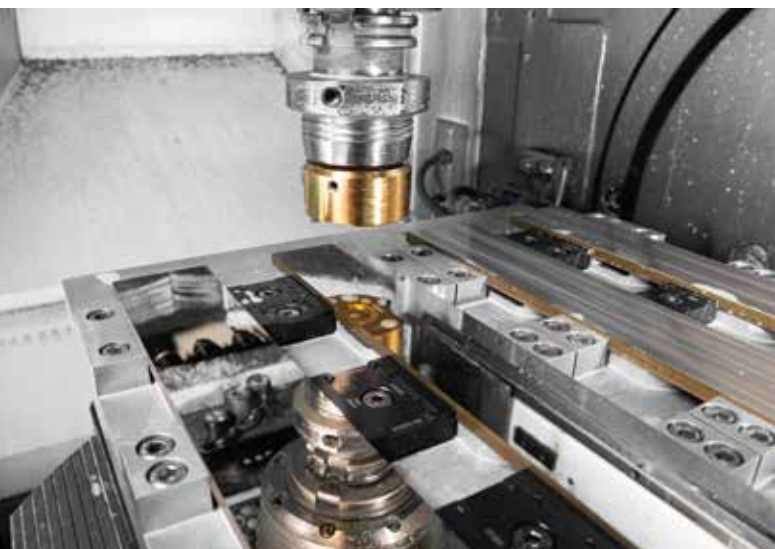
Le fraisage poli-miroir permet d'obtenir une planéité parfaite et des états de surface réfléchissants de l'ordre du nanomètre.
